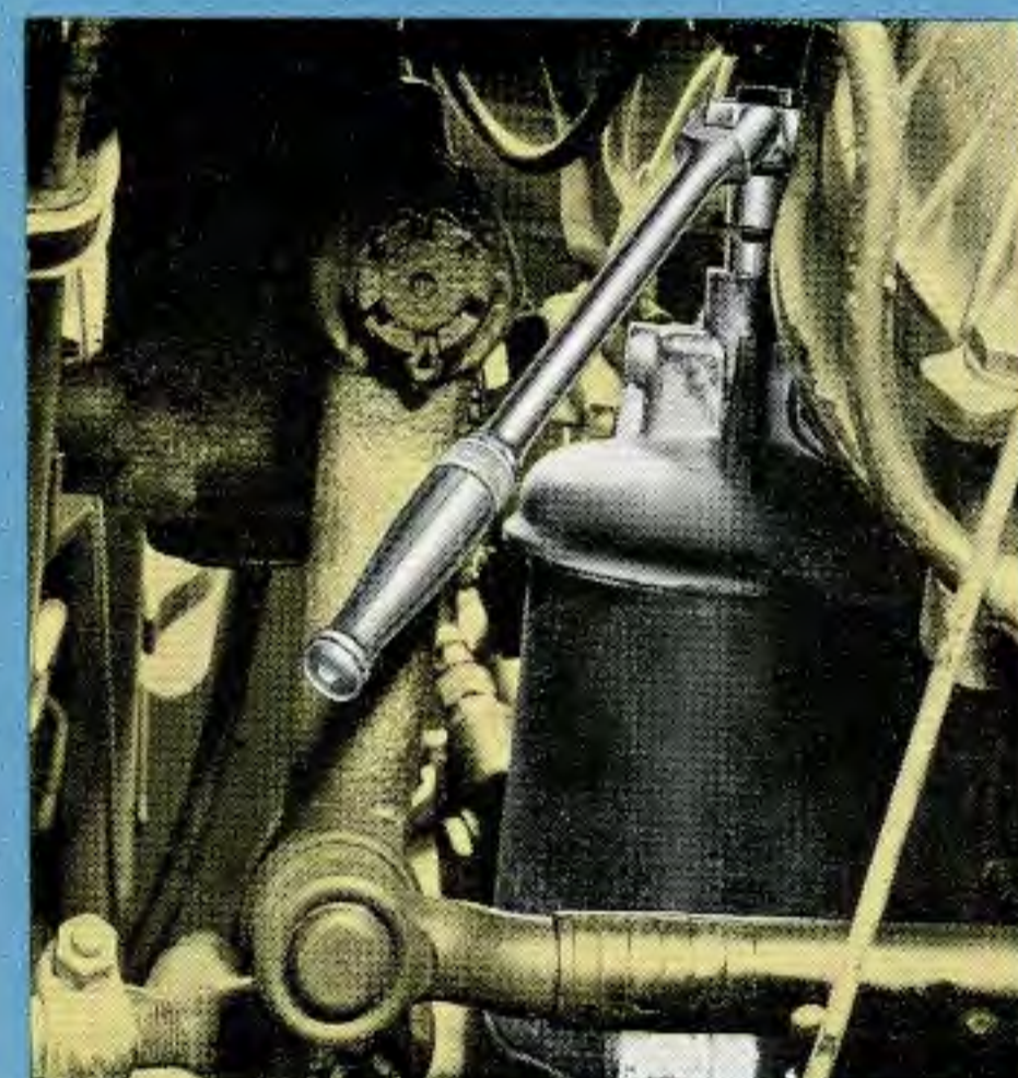
HAZET 2728-8 mit 8816 G für Ölfilterschraube an Mercedes 190 D und 200 D
