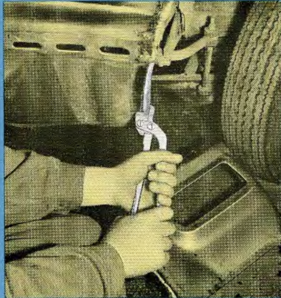
HAZET 1932 zum Absetzen von Blechkanten
