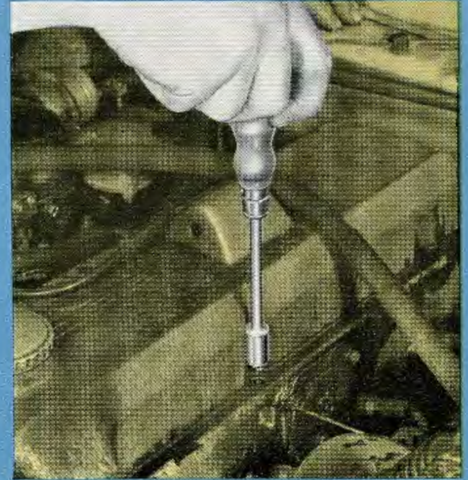
HAZET 421-10 mit Magnet für Ventildeckel-Schrauben an Opel
